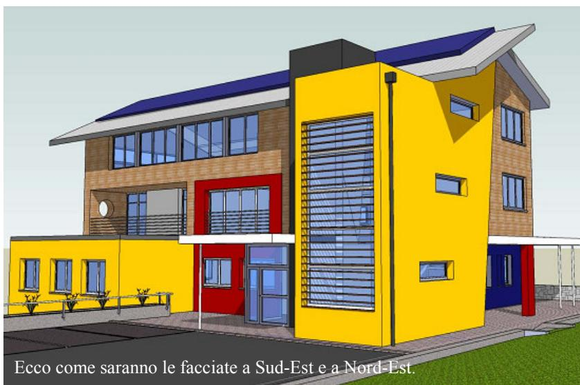
tende esterne in alluminio a lamelle, installate sui serramenti dei fronti est, sud e ovest; la sostituzione dei corpi illuminanti ad incandescenza con altri a fluorescenza a basso consumo e, dove possibile, la realizzazione delle accensioni delle luci attraverso sensori di presenza che rilevano il movimento;
