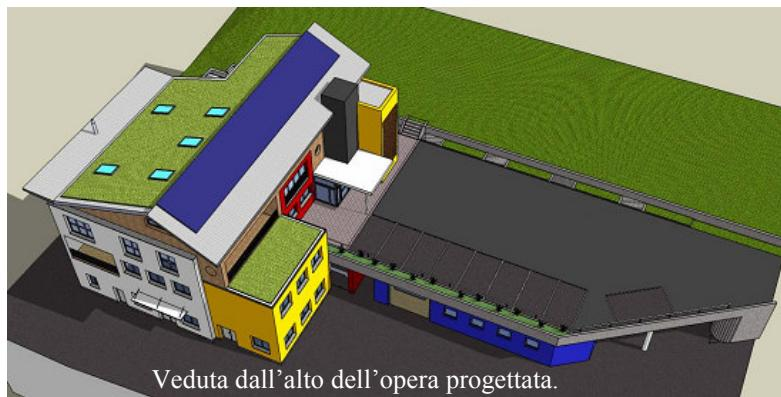
Dalla necessità di disporre di ulteriori spazi coperti a servizio del cantiere comunale è stato inoltre deciso di sfruttare il dislivello esistente tra Via Molini ed il piazzale della scuola materna per realizzare un nuovo magazzino seminterrato dove troveranno spazio l'autorimessa, il deposito per la sabbia e un deposito materiali e dove sarà ricavato pure un adeguato archivio.
